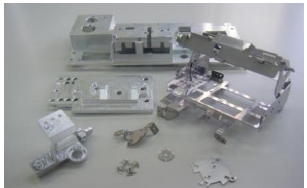
加工サンプル：アルミ(切削・鑄造)、板金
